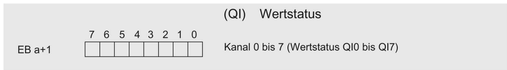
Bild 4-3 Adressraum bei Konfiguration als 1 x 8-kanaliges DI 8x24VDC HF QI mit Wertstatus
