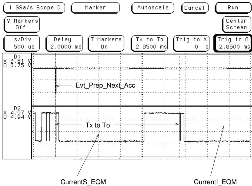
Abbildung 6: Laufzeit des Turbo\_CurrentS-EQMs bei 15 bedienten Magnete
