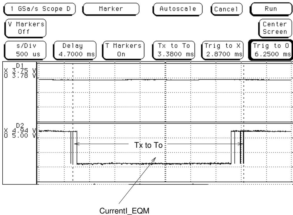
Abbildung 7: Laufzeit des Turbo\_CurrentI-EQMs bei 15 bedienten Magnete
